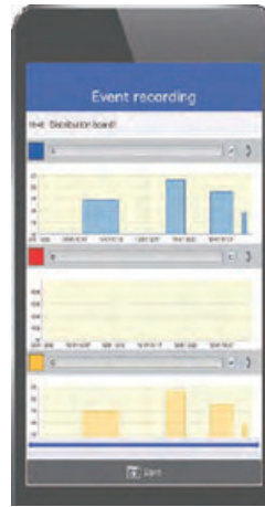
Registrar la ocurrencia de intermitente corriente de fuga
