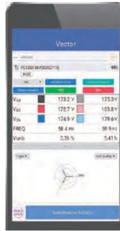
Visualización de tasas de desequilibrio y diagramas vectoriales
